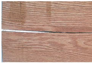
割れ 乾燥途中で生じる長手方向の割れ。年輪が分離するものをシェイク (shake) という。
