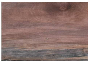
くざれ 菌類によって木質が劣化すること。辺材の変色が目印。
