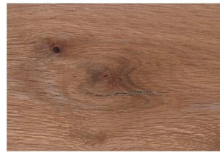
干潮れ 乾燥工程で乾燥が適切に行われなかった場合に生じる。
