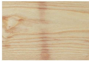
ステイン 乾燥工程で材の間に入れた算木によって生じた変色。灰色がかかった色合いが一般的。
